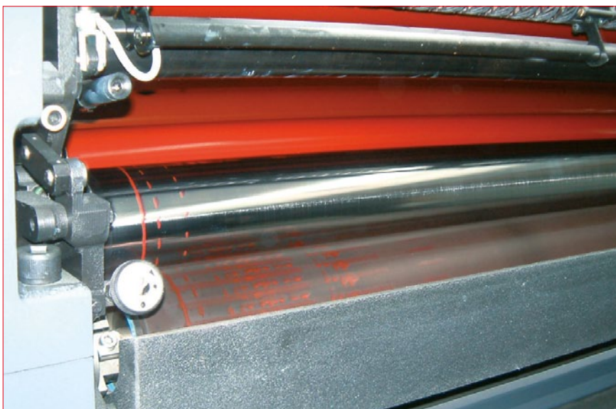
Abb. 6: Farbeintrag auf Chrom- und Tauchwalzen nach nur wenigen 100 Umrollungen.
