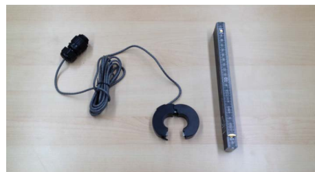
Abb. 4: Messwandler mit 25 mm Durchmesser. Die Kabel sind ca. 3 m lang.
